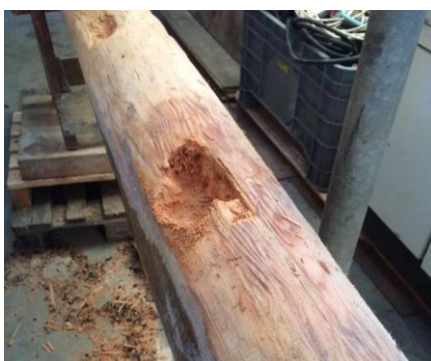
De top van de mast is flink verrot
